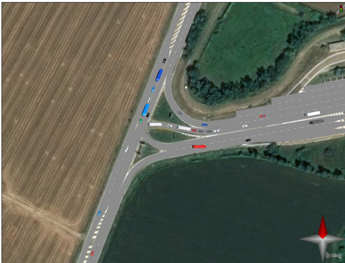
Img. 7.3 - Il modello di microsimulazione dell'intersezione A nello scenario attuale
