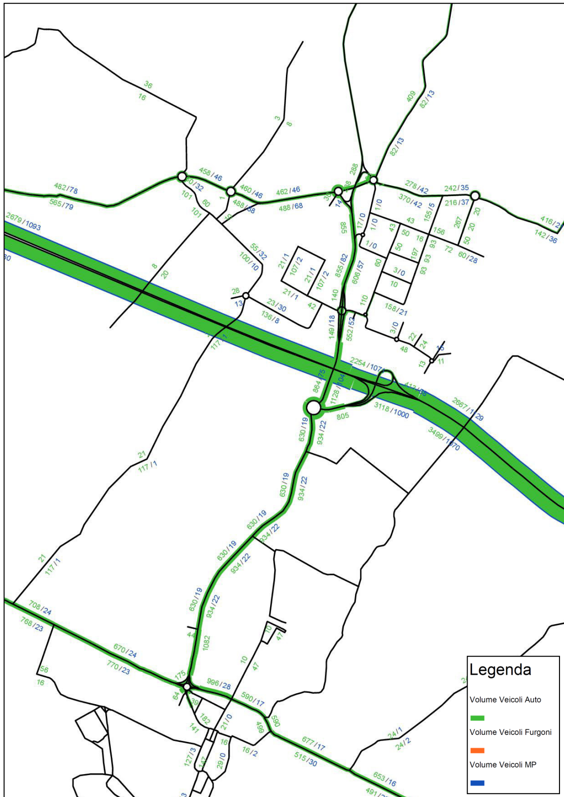
Img. 5.2 - Flussi di traffico nello scenario futuro con gli interventi infrastrutturali aggiuntivi – ora di punta della mattina 8-9
