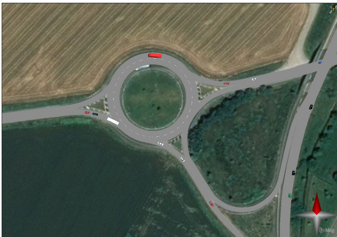
Img. 7.13 - Il modello di microsimulazione dell'intersezione C nello scenario attuale
