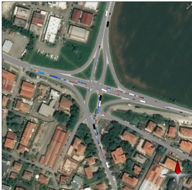
Img. 7.9 - Il modello di microsimulazione dell'intersezione B nello scenario attuale
