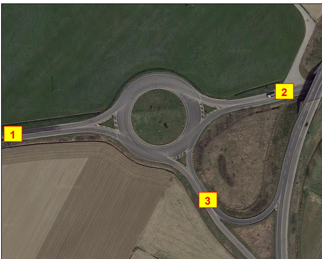
Img. 7.12 - Configurazione dell'intersezione C a rotatoria tra SP n.31 e SP n.19 nello scenario attuale
