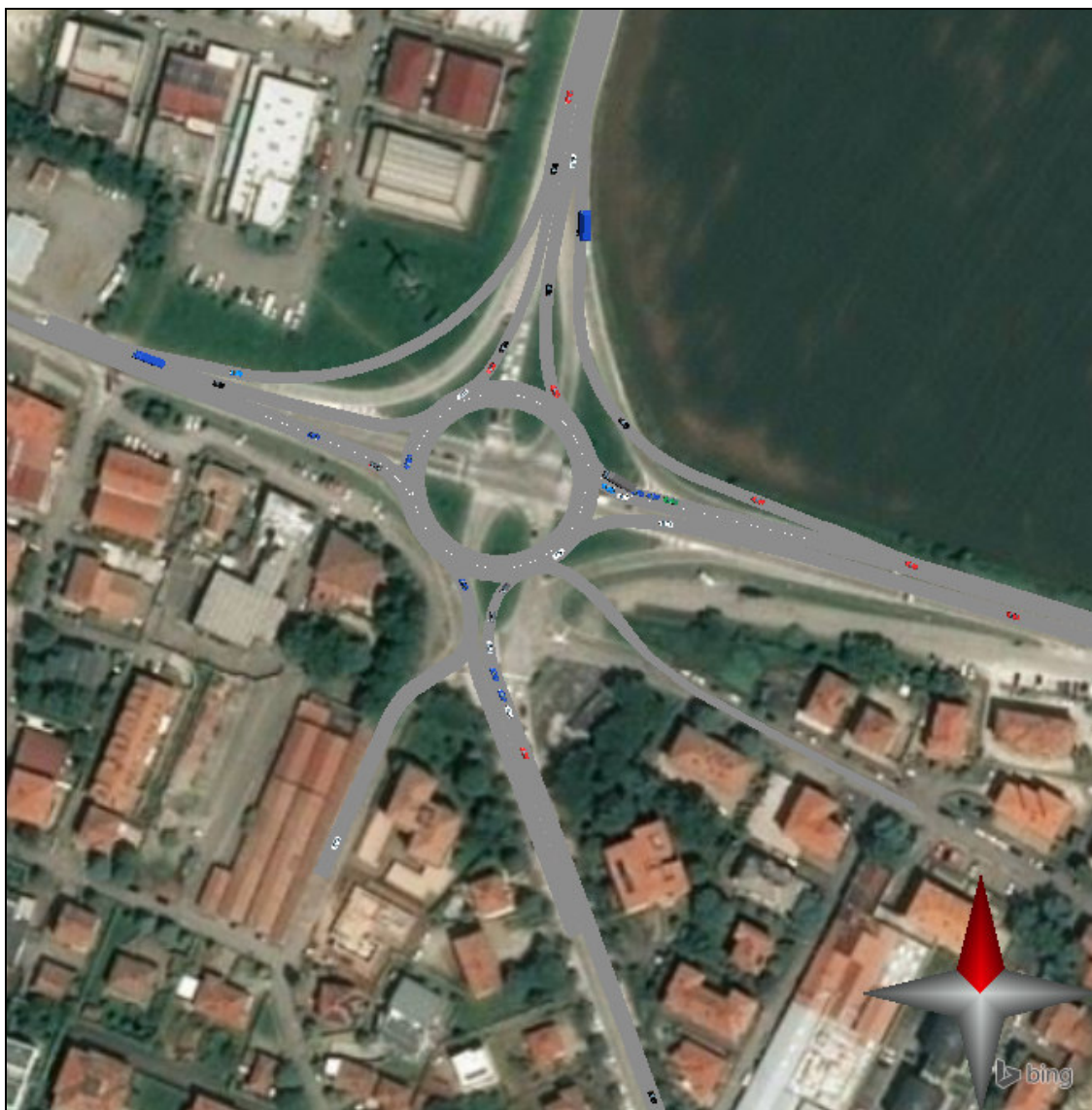
Img. 7.11 - Il modello di microsimulazione dell'intersezione B a rotatoria nello scenario di progetto
