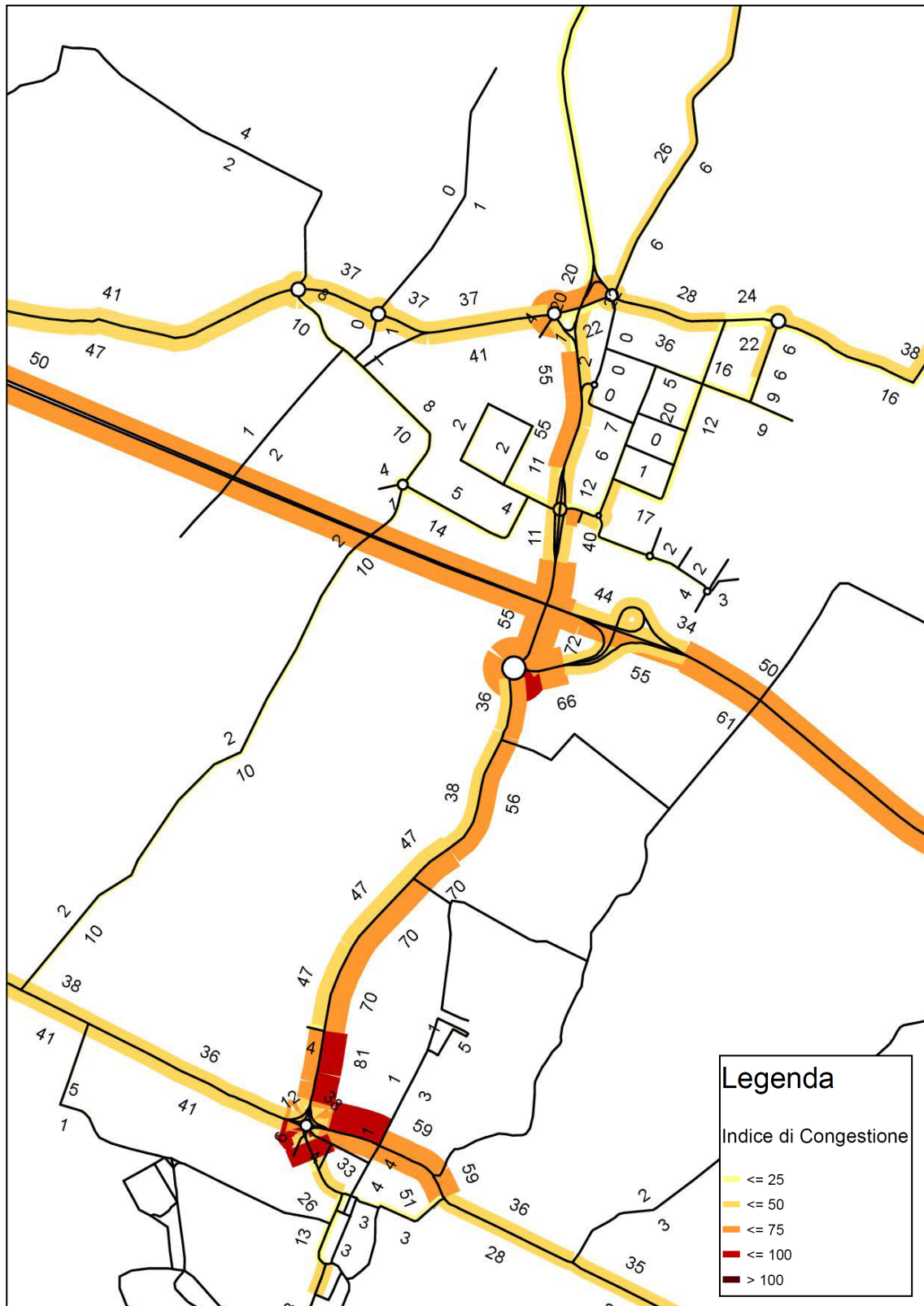
Img. 5.3 - Indice di congestione sugli archi della rete nello scenario futuro con gli interventi infrastrutturali aggiuntivi – ora di punta della mattina 8-9
