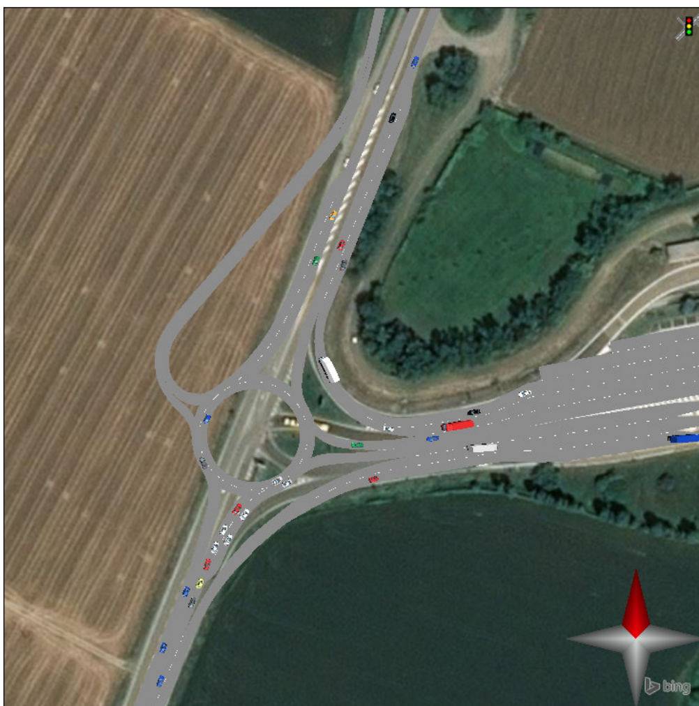
Img. 7.6 - Il modello di microsimulazione dell'intersezione A con configurazione a rotatoria nello scenario di variante con doppio attestamento sui rami della San Carlo
