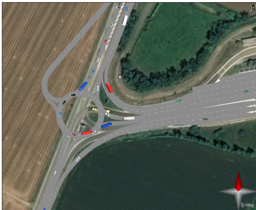
Img. 7.5 - Il modello di microsimulazione dell'intersezione A con configurazione a rotatoria nello scenario di progetto
